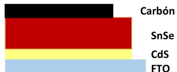
Figura 1. Estructura de la celda solar C/SnSe/CdS/FTO
